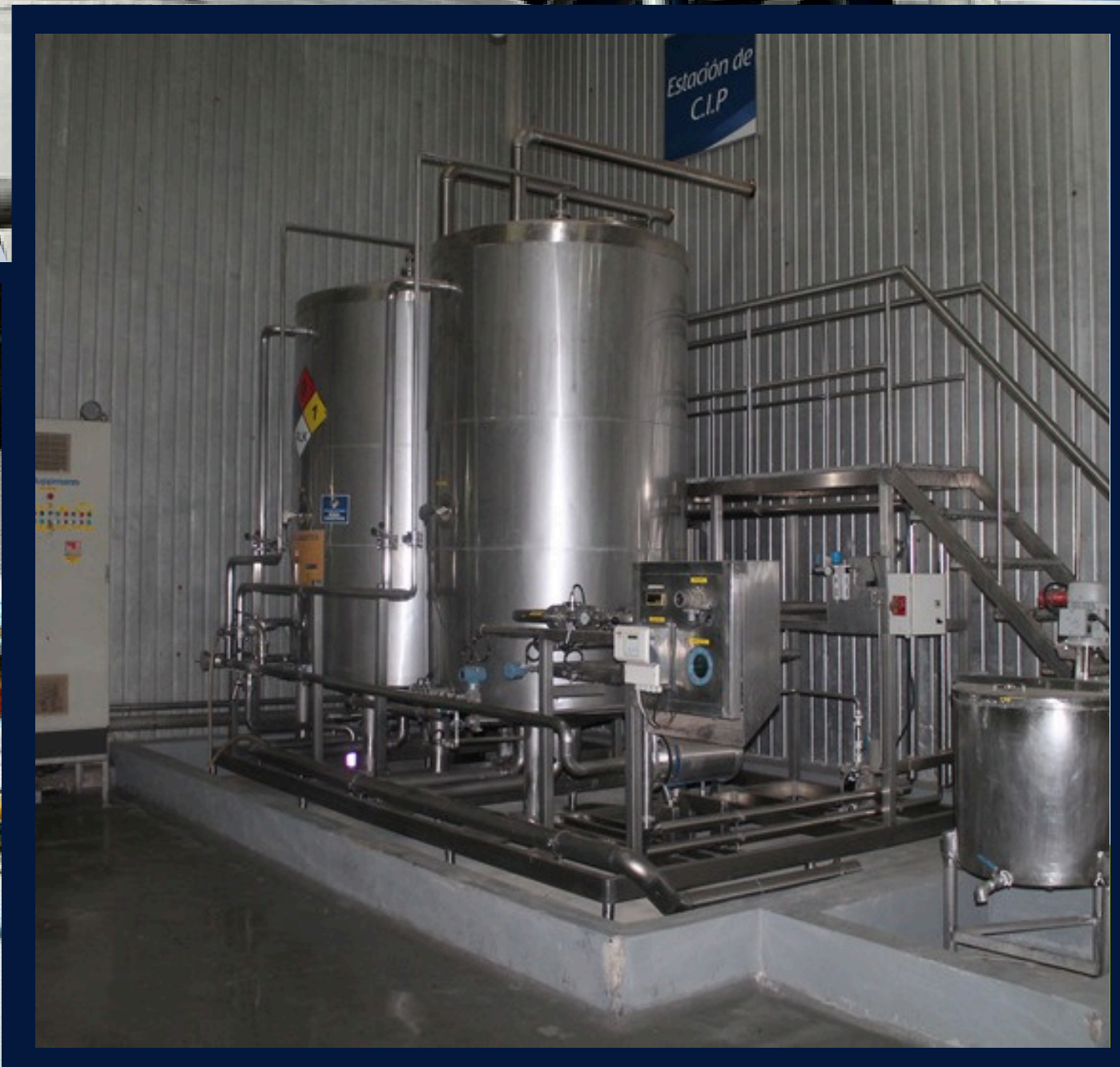
CIP (Cleaning In Place) Sistema de Limpieza para procesos productivos en acero inoxidable con acabo sanitario:
